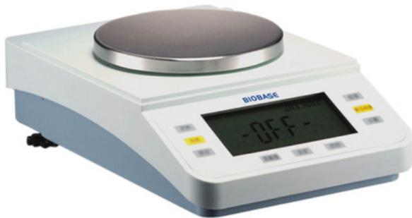
La Balanza Electrónica de Precisión Analítica Biobase BP12002 es un equipo diseñado para realizar mediciones de masa con alta exactitud y fiabilidad en entornos como laboratorios de investigación, control de calidad industrial y ambientes educativos. Con una capacidad de pesaje de hasta 1200 gramos y una legibilidad de 10 miligramos, esta balanza es ideal para tareas que requieren precisión intermedia entre una balanza analítica y una balanza industrial.
